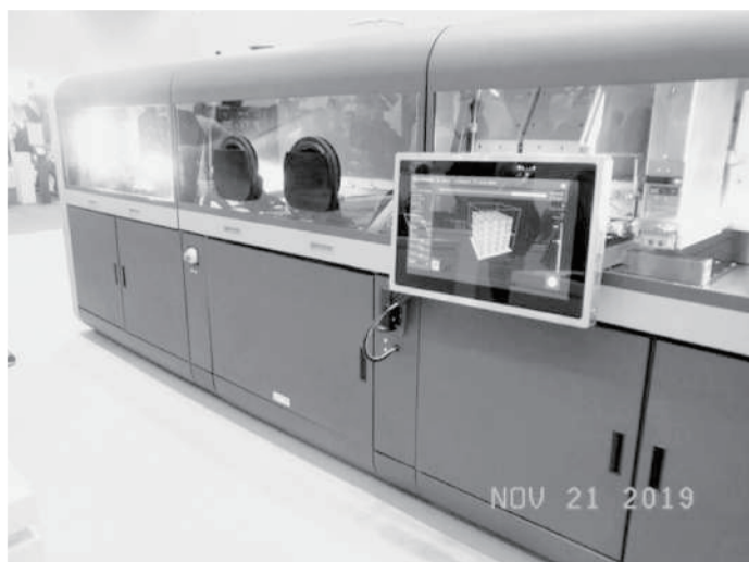
写真2 デスクトップ型金属のBJT方式3Dプリンター（Formnext 2019展示会で撮影）
